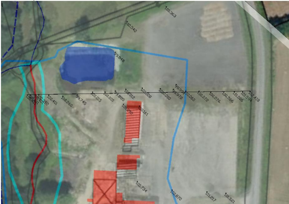
Figure 170 Profil altimétrique d'Est en Ouest de la parcelle du projet intégrant les limites des différentes crues
