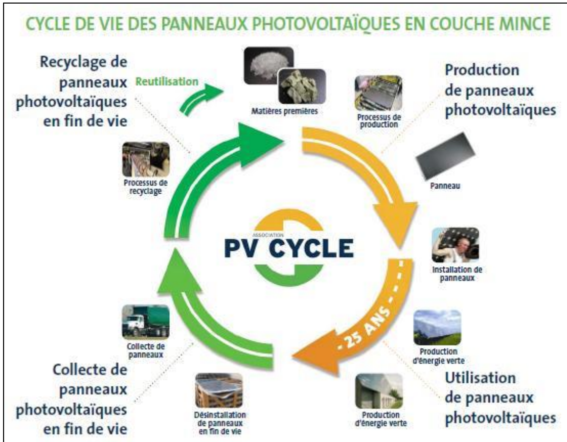
Figure 179 Cycle de vie des panneaux photovoltaïques en couche mince
